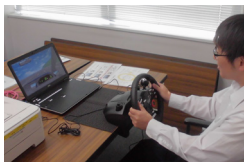
PC、ステアリング、ペダル、プリンターがセットになった卓上型ドライビングシミュレータ「ACM300」
