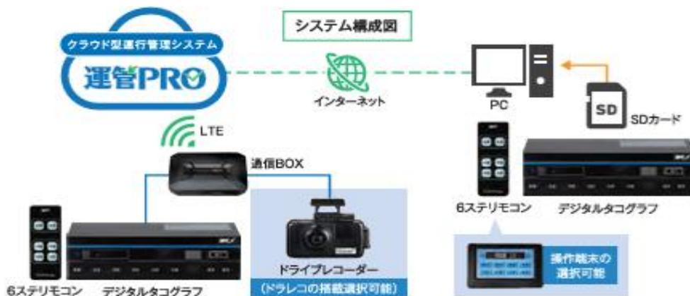
一般的なデジタコは様々な機能を搭載したカメラ一体型デジタコが主流ですが、運管 PRO 車載器システムはあえて分離、必要な機器を必要な時期にスモールスタートからの導入が可能となります。
